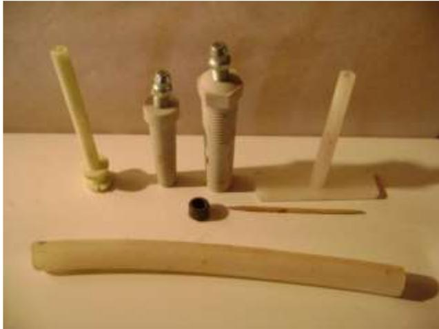
11. Plusieurs types de douilles d'injection possible. Le type de douille choisie sera déterminé par la fissure. Largeur en particulier.
